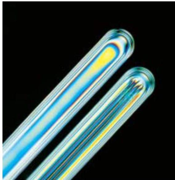
Рефлексионное стекло KLINGER (справа) в поляризованном свете
