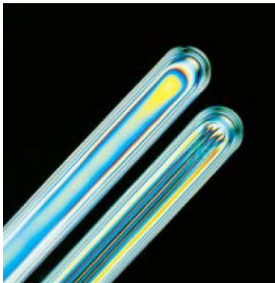
Транспарентное стекло KLINGER (слева) в поляризованном свете
