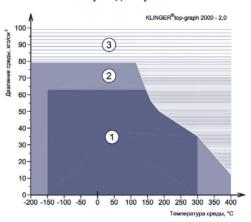
Диаграммы давление-температура действительны для прокладок толщиной 2 мм, шириной не менее 20 мм. Если параметры рабочей среды находятся в зоне 1, предварительное проведение испытаний не требуется, в зоне 2 проведение испытаний рекомендуется, в зоне 3 проведение испытаний обязательно
