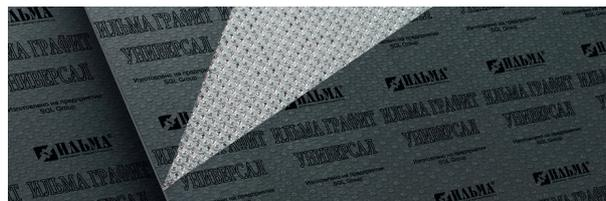
**ИЛЬМА ГРАФИТ УНИВЕРСАЛ** – листовой уплотнительный материал из графитовой фольги SIGRAFLEX, армированный перфорированной сталью 316(L) толщиной 0,1 мм, изготовленный без применения клея,
