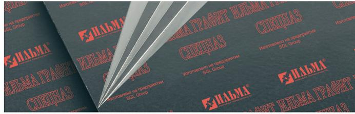
**ИЛЬМА ГРАФИТ СПЕЦНАЗ** – многослойный листовой уплотнительный материал, изготовленный без применения клея, из графитовой фольги с антиоксидантом толщиной 0,5 мм, армированной нержавеющей сталью толщиной 0,05 мм.
