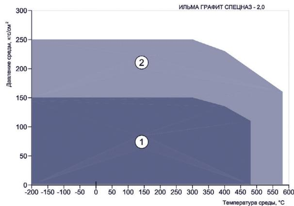
Диаграммы давление-температура действительны для прокладок толщиной 2 мм, шириной не менее 20 мм. Если параметры рабочей среды находятся в зоне 1, можно применять прокладки без консультации, в зоне 2 рекомендуется консультация с производителем
